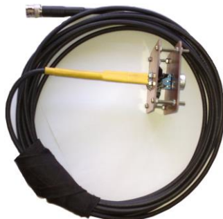
شکل ۱: سنسور فراصوت SSQC-SQ ۴۰R متصل به یک کابل کواکسیال ۵۰ اهم
