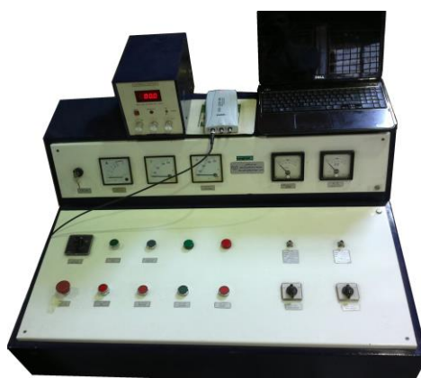
شکل ۲: مجموعه میز کنترل ولتاژ به همراه پیک ولت‌متر، کارت آنالوگ به دیجیتال و رایانه مورد استفاده در آزمایشگاه تخلیه‌جزئی
