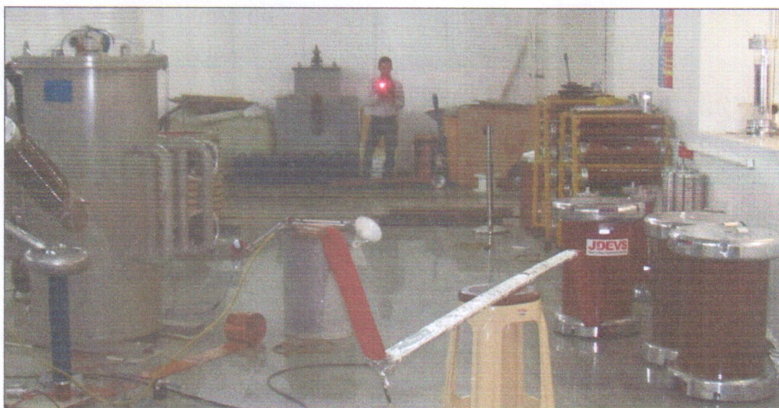
شکل (۳): اندازه گیری با استفاده از دستگاه بازرسی نشتی و مکانیابی تخلیه جزیی بر روی شینه ژنراتور ۱۵.۷۵ کیلوولت
