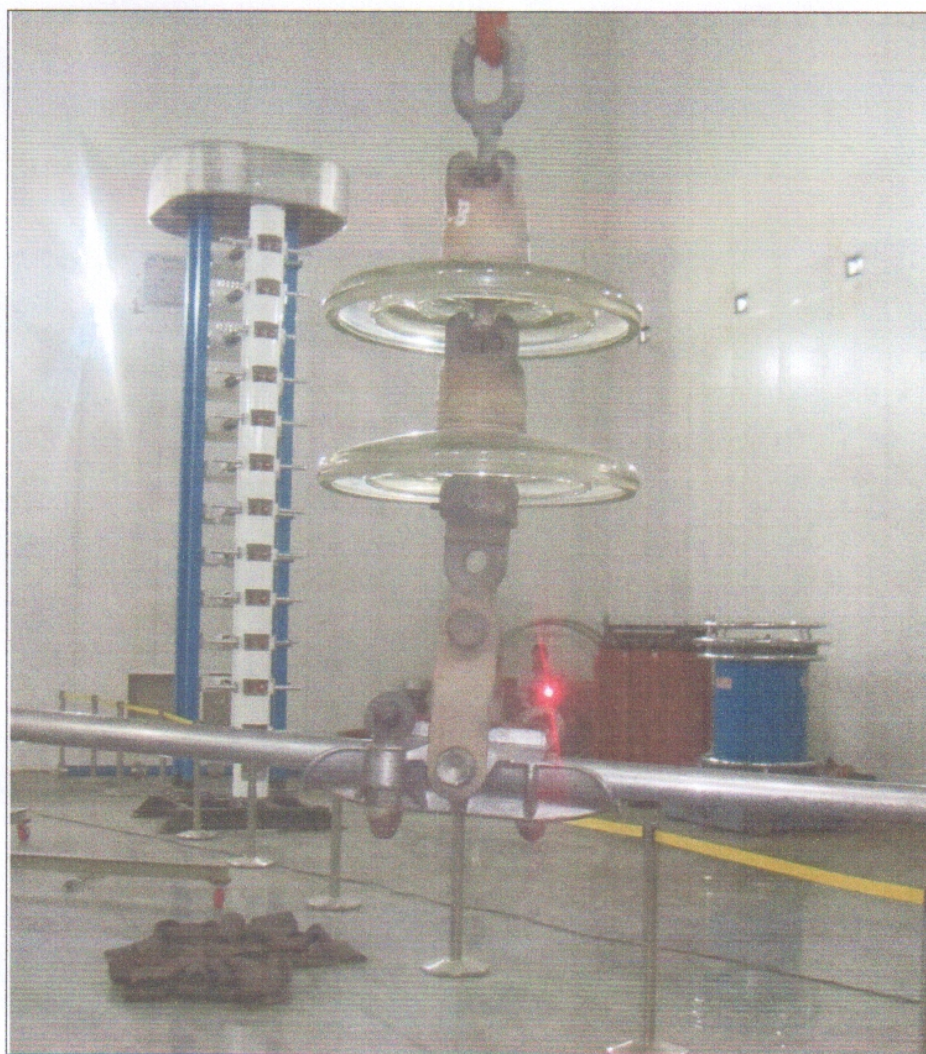
شکل (۴): اندازه گیری با استفاده از دستگاه بازرسی نشتی و مکانیابی تخلیه جزیی بر روی زنجیره مقره شیشه‌ای دوتایی خط ۲۰ کیلوولت
